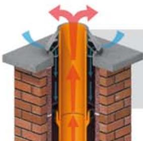
Unutarnja cijev idealnog dimnjaka je od šamota.
